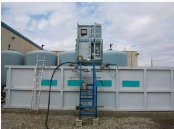
Planta piloto para el estudio de la dilución de salmueras
